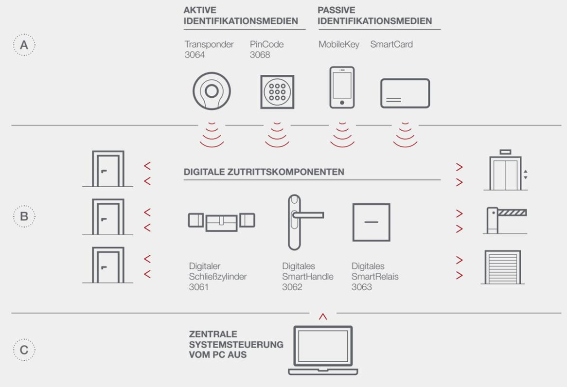
Das Zusammenspiel zwischen Identifikationsmedium (A), intelligenten Schließzylindern bzw. Relais-Schaltungen (B) sowie der Locking-System-Management-Software (C) für die Systemkonfiguration ermöglicht ein optimales Zutrittsmanagement für Behörden und Ämter.
